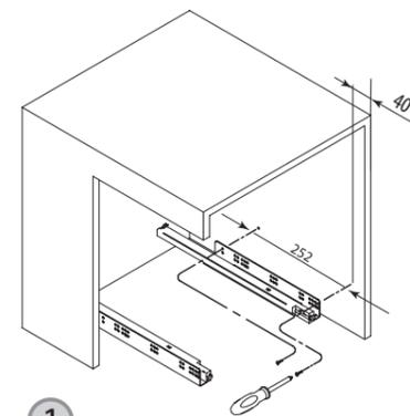
1 Делаем разметку под присадку (см. рисунок) с обеих сторон. Сверлим «слепые отверстия» глубиной не менее 8 мм.
