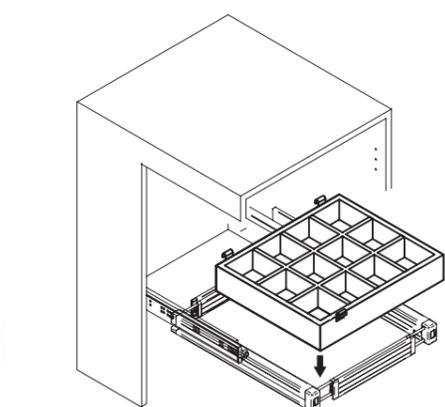
5 Устанавливаем корзину секционную на раму.
