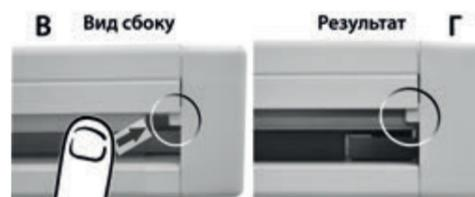
4 Вставляем фиксаторы с тыльной стороны изделия (рис. А) по направлению стрелки (рис. Б) и одновременно сбоку (рис. В) регулируем направляющую немного заправляя ее за пластиковую клипсу до щелчка (рис. Г)
