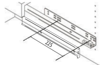
3 Закрепляем направляющие (Б) с помощью винтов (З) на стенках модуля. Высота регулируется на Ваше усмотрение. Фиксируем накладки (В) на креплениях направляющих (Б) с помощью винтов (З).
