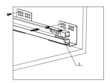
3 Установите корзину на направляющие, зафиксируйте винтами (болтами) В и фиксирующей пластиной D, затем установите держатель для поддона (F) на корзину и зафиксируйте винтами (болтами) С.
